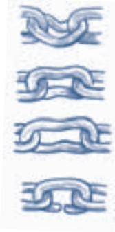
Chaînes usées ou mauvais état
